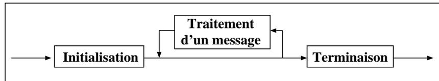
Figure 5.6 : Schéma d'exécution général d'un agent.
